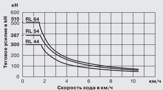
Реализация тягового усилия зависит от веса машины и сцепления с грунтом.
