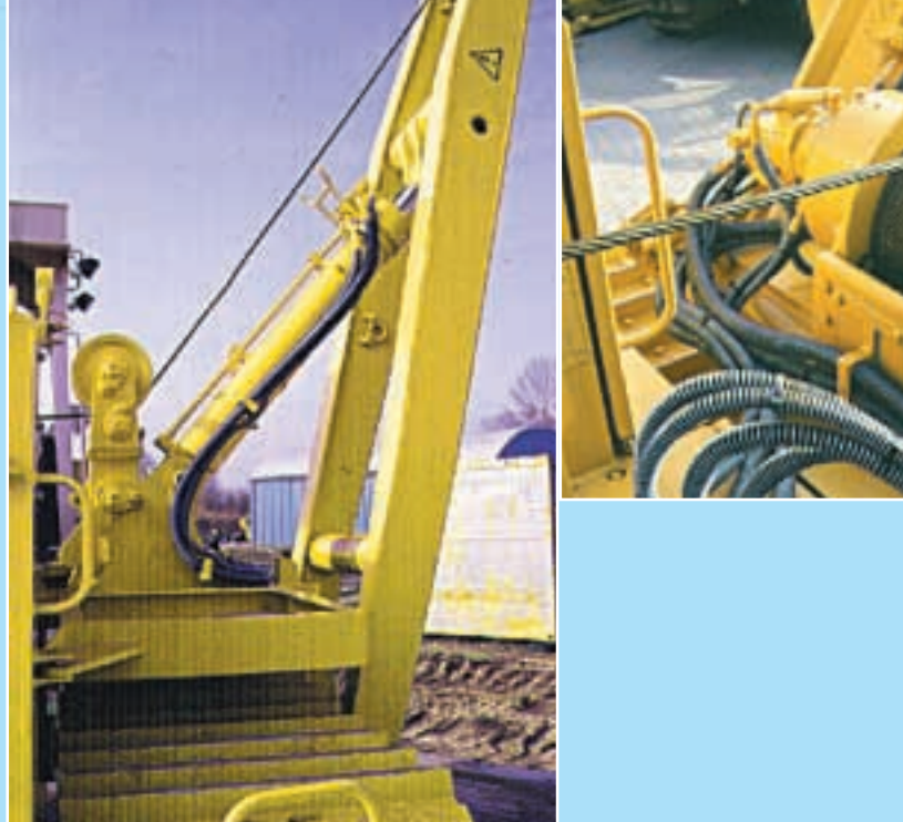
Стрела перемещается точно и плавно при помощи гидроцилиндра.
